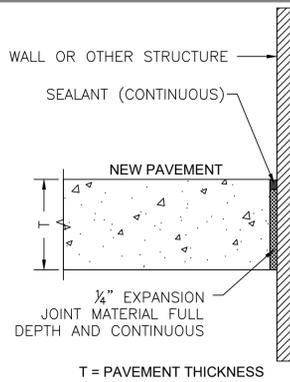
2 CONSTRUCTION TYPE BUTT JOINT (BCJ)
